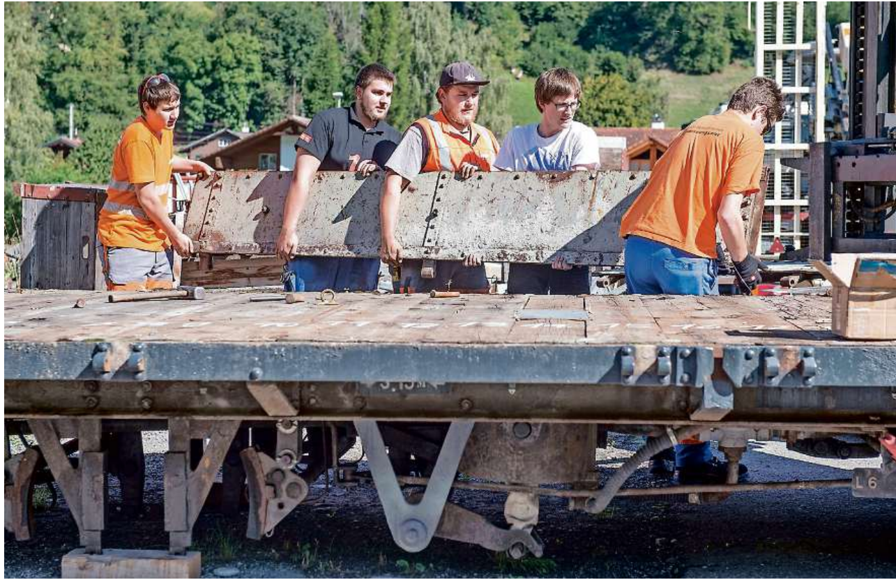
Gian-Andrea Braun, Samuel Mohr, Jonas Krummenacher, Maurus Schaffner und Livio Caduff (oben von links) packen alle mit an, um eine Seitenwand von M 7070 auf den Gabelstapler zu legen. Zuvor sind alle Schrauben gelöst worden.
