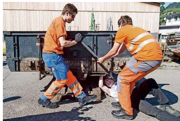
Gian-Andrea Braun, Samuel Mohr, Jonas Krummenacher, Maurus Schaffner und Livio Caduff (oben von links) packen alle mit an, um eine Seitenwand von M 7070 auf den Gabelstapler zu legen. Zuvor sind alle Schrauben gelöst worden.
