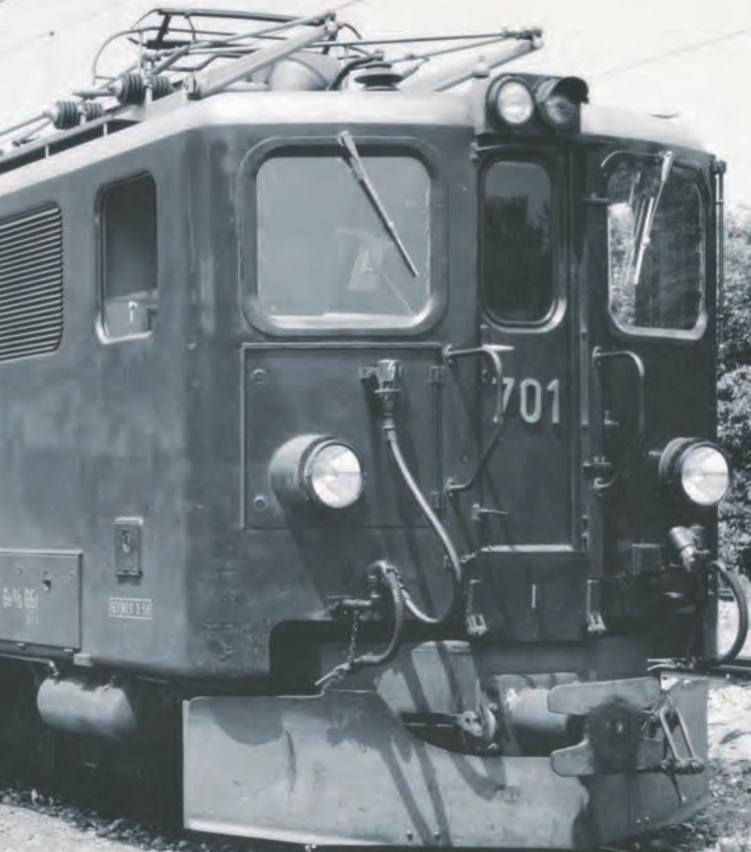
schwere Züge die 35 Promille steile Albulastrecke hinauf zu schleppen, was der damals maximal zulässigen Belastung der Kupplungen entsprach. Damit konnte das Tagessoll – 1000 Tonnen Zement – mit vier Fahrten erfüllt werden.
