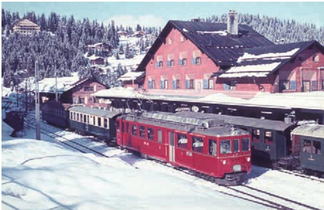
Sie waren Vorbild für den neuen Misoxer-Triebwagen: Die ab 1957 auf der Strecke Chur–Arosa eingesetzten ABFe 4/4 481–486. Am 24. März 1963 wartet Triebwagen 483 in Arosa auf die Fahrt hinunter nach Chur. Dieser Triebwagen konnte zusammen mit dem Schwesterfahrzeug 484 dank einer elektrischen Umschaltvorrichtung auch auf der Strecke Bellinzona–Mesocco eingesetzt werden (siehe Seite 31).
