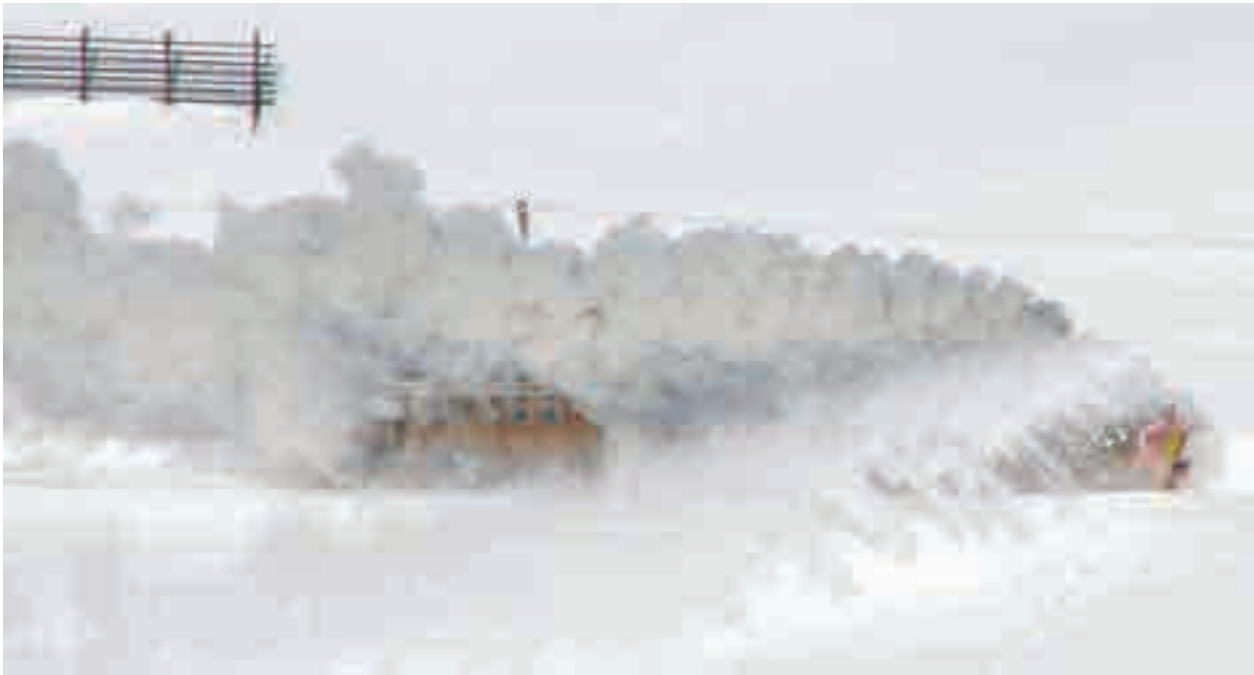
«Schnee und Eis» am 19.1.2013: Die Dampfschneeschleuder wird von der Ge 4/4 Nr. 182 gestossen. Diese Lok wurde vom Club 1889 restauriert und verzückt zahlreiche Eisenbahnfans. Der Schnee indes zerstört auf der anderen Seite frei herumstehende Eisenbahnwagen.
