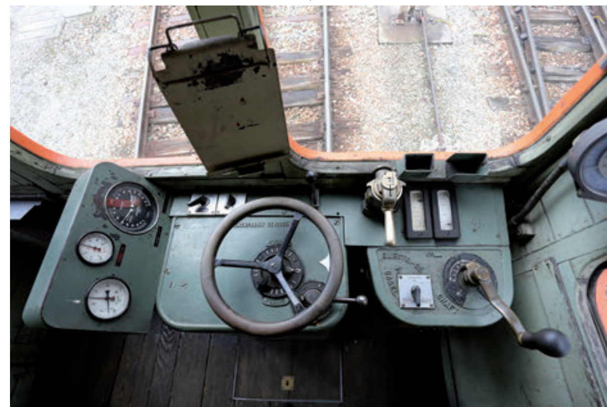
Rudimentär: Der Führerstand mit dem hölzernen Handrad des Fahr-/Bremskontrollers, dem Druckluft-Rangierbremsventil, dem Schalter für die Magnetschienenbremse und dem Controller der Vakuumbremse.
